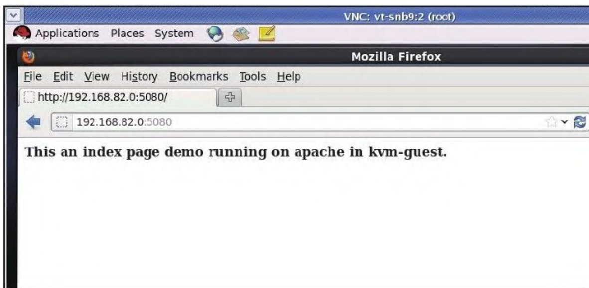
图 4-9 在宿主机转发功能作用下，外部网络得以访问用户模式网络中的客户机
