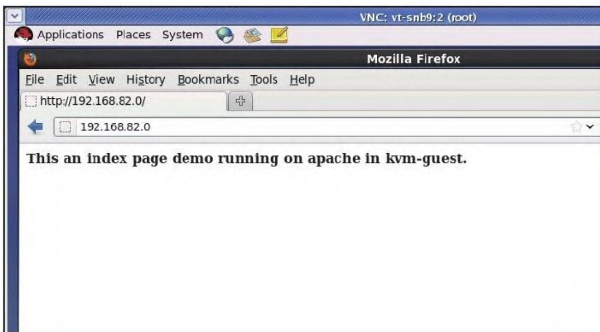
图 4-8 外部网络主机访问宿主机而被映射到客户机中相应的端口
